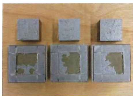
イヌバシールの破断状況
