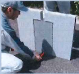
発炎筒点火 発炎筒を点火し、シートに押し付けて燃焼を開始。
