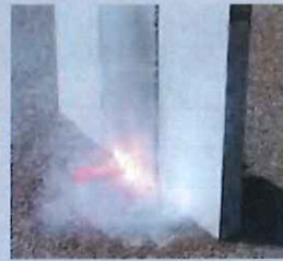
着火2分後 発炎筒に接触している部分から燃焼しているが、2分経過しても延焼していない。
