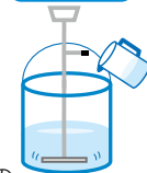
練混ぜ水の計量
